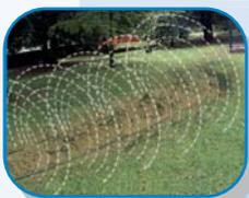
Sensor perimetral enterrado "invisible" basado en señales de radiofrecuencia. Detecta las variaciones en el campo electromagnético generadas por el intruso que cruza el área sensible.
