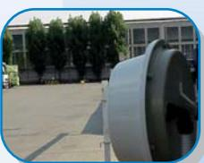
Con rangos de hasta doscientos metros, disponen de un circuito que permite ajustar los patrones de detección en la instalación. Funcionan en un amplio margen de temperatura. Permiten utilizar más de una barrera en el mismo área de protección sin riesgo de interferencias.
